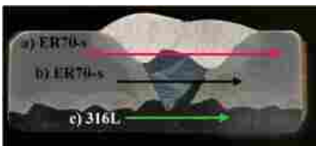
Figura 8. Niveles en que se realizaron los barrios de microdureza Vickers en la junta soldada.
